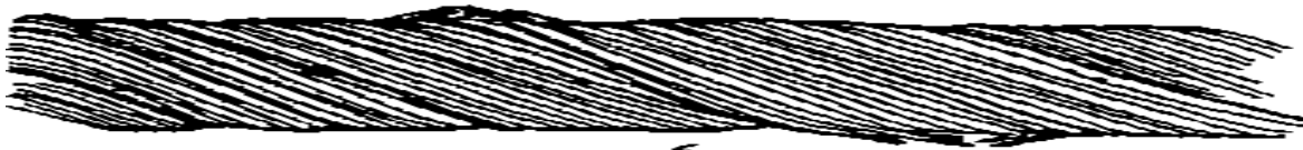
Сочетание обрывов проволок с их износом:
